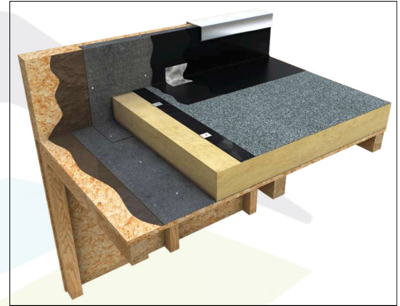
Etanchéité bitumineuse avec isolant selon le résultat de l'étude thermique, avec couvertines laquées
