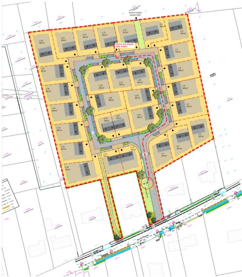
La défense incendie pour ces nouvelles parcelles sera assurée par l'installation d'une cuve enterrée. Cette cuve permettra de respecter le débit d'extinction minimal de 60m<sup>3</sup>/heure préconisé et la distance de moins de 400m jusqu'à la porte d'entrée la plus éloignée (sur le plan ci-dessous, le point le plus éloigné est de 160m).
